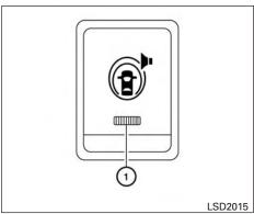
Warning systems switch **FCW SYSTEM OPERATION**
