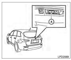
Liftgate opener switch OPERATING THE POWER LIFTGATE
